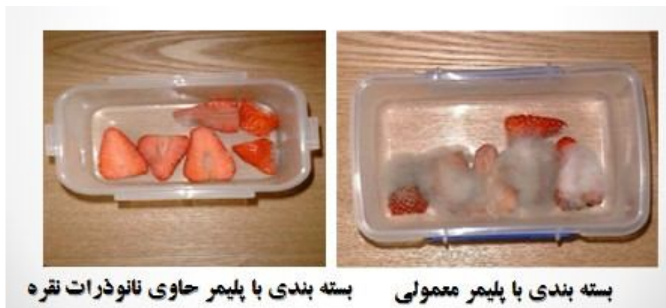
شکل ۵- مقایسه فساد مواد غذایی در یک بسته‌بندی حاوی نانوذرات نقره با یک بسته‌بندی فاقد این نانوذرات.
