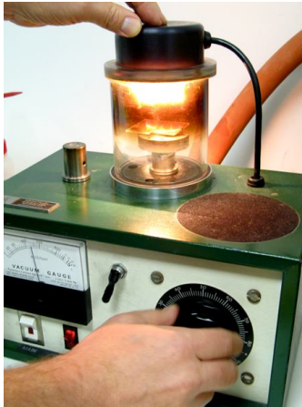
شکل ۵- شمایی از دستگاه کندوپاش جهت پوشش‌دهی نمونه SEM [۱۰]
