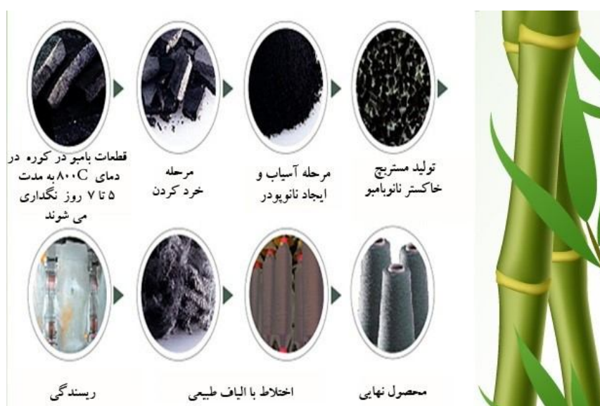
شکل ۸- نحوه تولید الیاف با استفاده از خاکستر بامبو.
